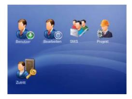
Um einem im Terminal bereits vorhandenen Mitarbeiter einen Transponder zuzuordnen oder einen Fingerabdruck anzulernen, wählen Sie **Bearbeiten** und drücken die Taste **OK**.
