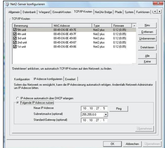
Klicken Sie auf **Detektieren**. Nun sollte die MAC-Adresse des TCP/IP-Interface im Feld "TCP/IP-Knoten" angezeigt werden. Danach müssen Sie auf die Registerkarte "IP-Adresse konfigurieren" klicken und die IP-Adresse, die Subnetzmaske und das Gateway manuell konfigurieren.
